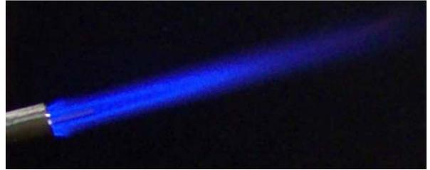
**Regolazione corretta della fiamma con ritenzione fiamma innescata all'interno dell'estremità della testa del pilota.**
