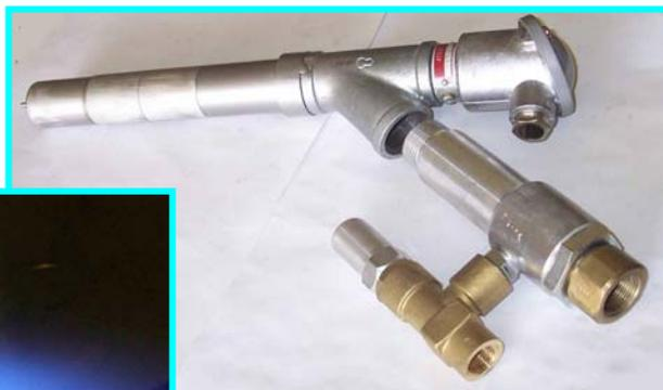
Bruciatore pilota ad aria soffiata con monoelettrodo di accensione e rivelazione incorporato internamente, completo di premiscelatore aria-gas con dosatore sensitivo di regolazione della portata del gas.
