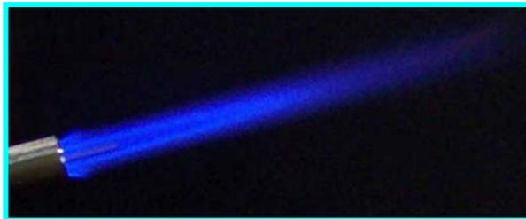
Regolazione corretta della fiamma con ritenzione fiamma innescata all'interno dell'estremità della testa del pilota.
